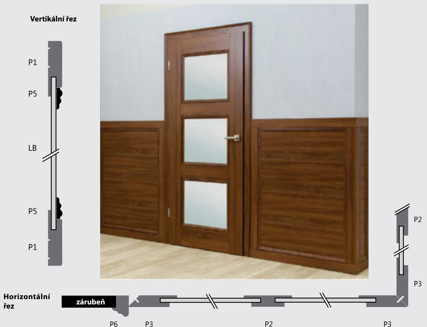
Schéma provedení rohového obkladu stěny
